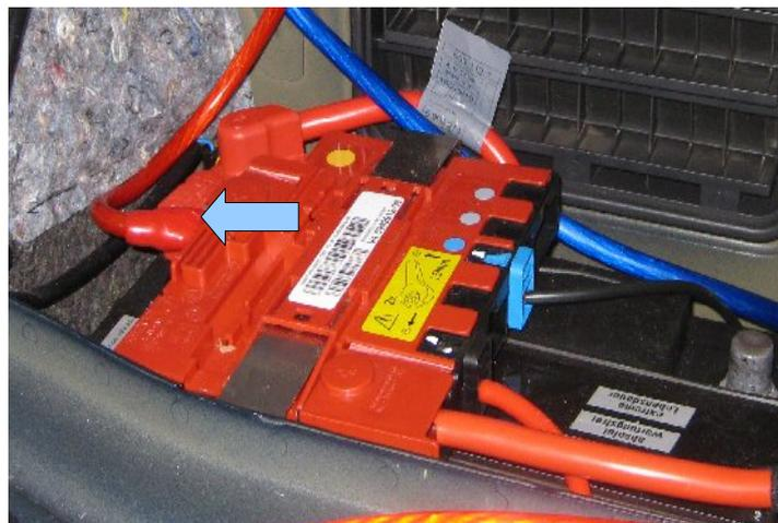
Abb. 9 Batteriemodul mit zusätzlichem Plus-Kabel
